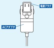
電源プラグをACアダプタへ図のように差し込み、 下へ押し込みます。
